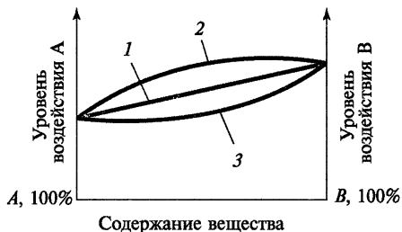
Рис. 6.9. Виды комбинированного действия смеси двух вредных веществ А и В: 1 — аддитивное действие; 2 — синергизм (потенцирование); 3 — антагонизм
